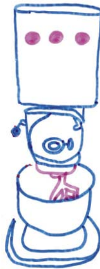
Figura 47 – Esquema do misturador para fabrico da argamassa normal para posterior determinação da resistência de um cimento.
