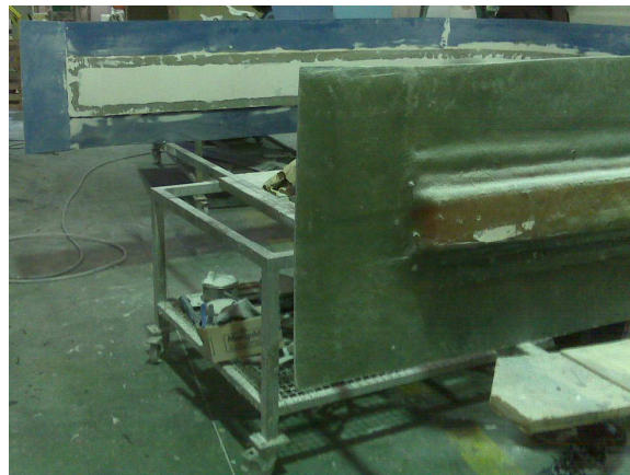
Figura 11: molde e contra-molde do pilar
