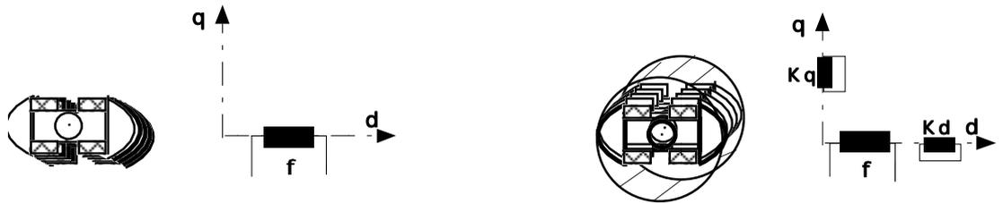
Se a máquina possuir pólos folheados e um circuito amortecedor completo já a assimetria eléctrica poderá ser menor, porque para além do circuito eléctrico indutor desaparece a representação das correntes de Foucault, embora ainda se considere a existência de circuitos eléctricos equivalentes aos enrolamentos amortecedores segundo os dois eixos, o que torna maior o equilíbrio da importância dos circuitos eléctricos segundo os eixos magnéticos.
