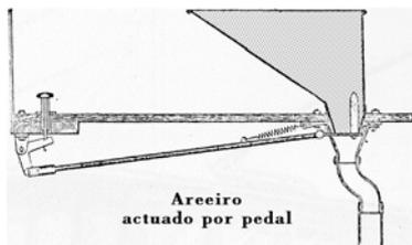
*Surgem situações interessantes na variação do valor do coeficiente de aderência: com os carris húmidos o coeficiente de aderência piora, mas se ocorrer uma forte chuvada o valor do coeficiente de aderência melhora; o lançamento de areia (fina e seca) sobre os carris melhora o coeficiente de aderência.*
