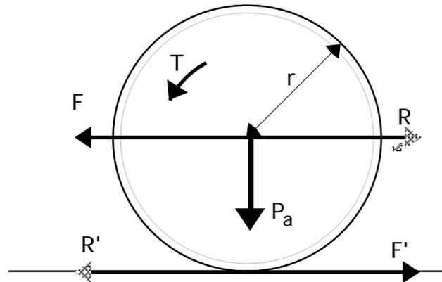
A resultante das diversas resistências parciais presentes em cada momento é representada pelo esforço resistente  $R$  reduzido ao eixo do veio da roda.
