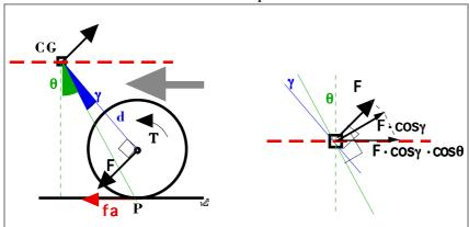
Para que o móvel se desloque a velocidade constante, é necessário que a acção resistente da força de atrito {dissipadora de energia} seja cancelada.
