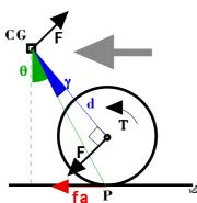
numa superfície plana horizontal mas que provoca atrito, e que tem o seu centro de gravidade CG a uma certa distância d do eixo de rotação da roda. A linha de ligação do centro de gravidade CG ao ponto de contacto da roda com a superfície de deslocamento P forma um ângulo  $\theta$  com a vertical. Devido ao tamanho da roda o segmento de recta d forma um ângulo constante  $\gamma$  com o segmento CG-P.
