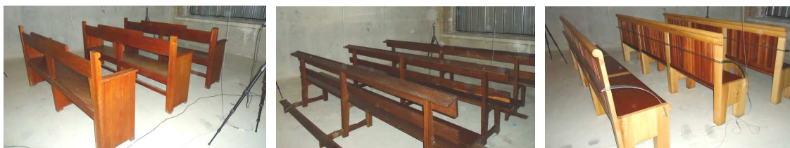
Fig. 1, 2 e 3 – Bancos tipo F (esq.), A (centro) e N (dir.) no interior da câmara reverberante
