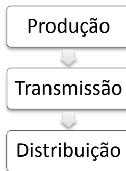
Figura 2.3 - Zonas funcionais do sistema eléctrico de energia
