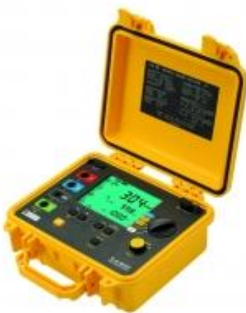
Figura A.1 - Aparelho para medição da resistividade do solo e da resistência de terra.
