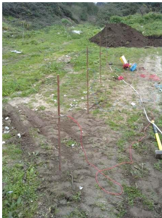
Figura B.1 - Medição da resistividade do solo através do método de Wenner.
