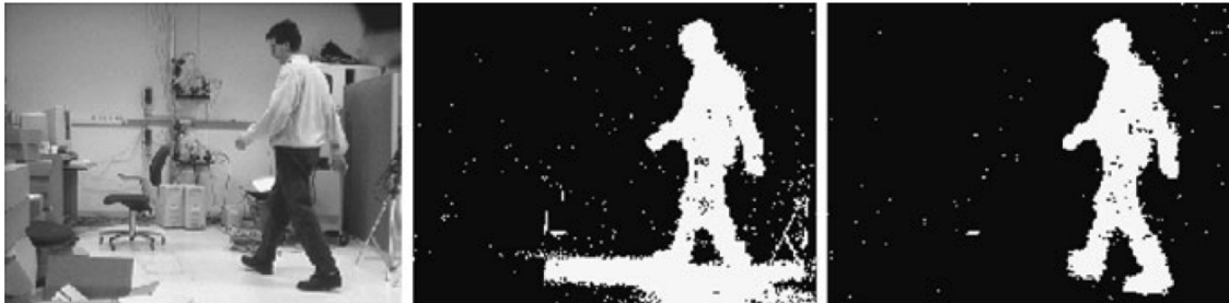
Figura 2.2: Esquerda imagem original; Centro resultado da detecção usando o espaço (R, G, B) ; Direita resultado da detecção usando o espaço (r, g) . Adotado de [3].
