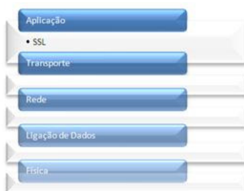
Figura 7 – SSL no modelo TCP/IP.
