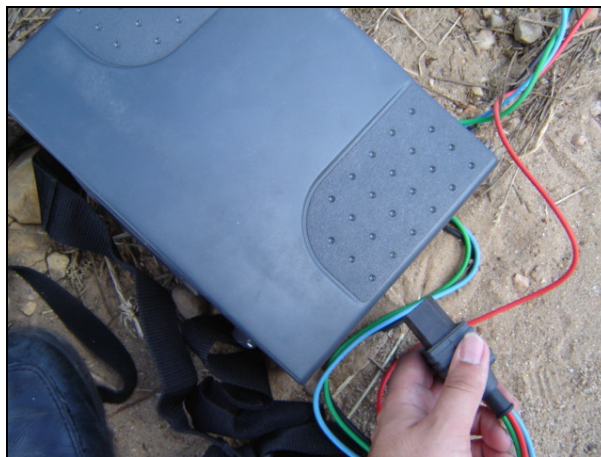
Fig. 50 - Paços (Valença) : Conector para os cabos dos eléctrodos (marcados com cores)
