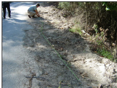
Fig. 52 - Corda utilizada para medir espaçamento (Esporões-Braga)
