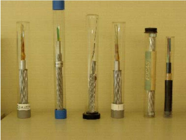
Exemplos de cabos de guarda com fibra óptica no seu interior.
