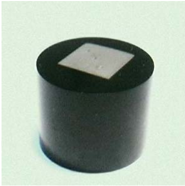
Fig. 13 - Amostra 1, envolta em resina fenólica preta, polida e atacada quimicamente, com marcas do indentador do teste de dureza Brinell
