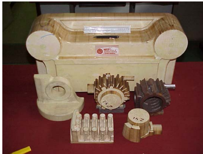
Figura 8 Modelos em LOM para fundição.
