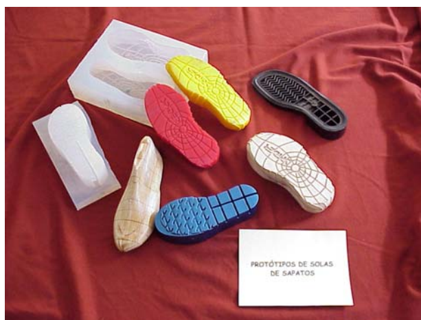
Figura 11 Solas de sapatos obtidas a partir de modelos em LOM.
