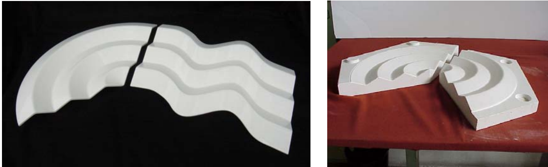
Figure 3 Moldes em gesso vazado sobre modelo da peça em LOM sobredimensionado com a contracção.
