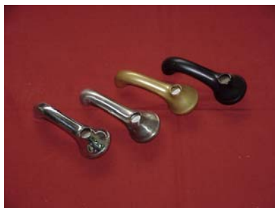
Figura 13 Protótipos de torneiras em latão e aço inoxidável obtidas por cera perdida, a partir de modelos de PR..
