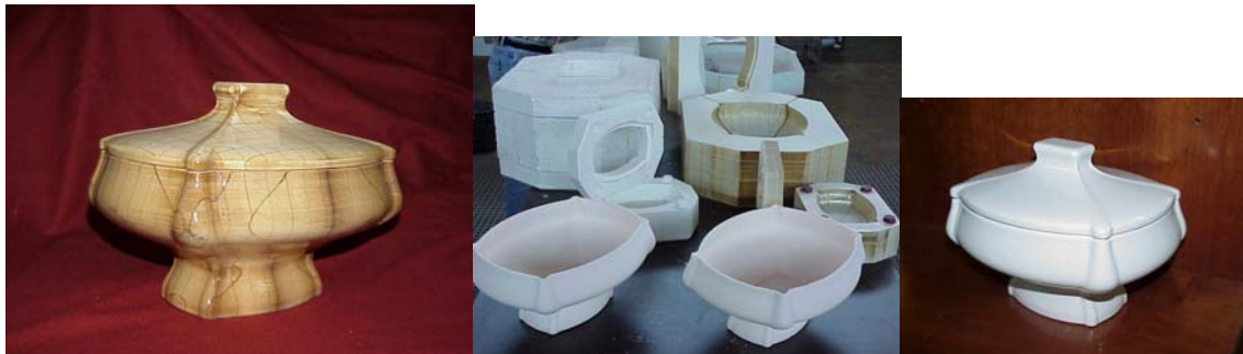
Figura 1 Modelo em LOM de terrina, ferramentas rápidas obtidas a partir de “madres” em LOM e terrina em porcelana.
