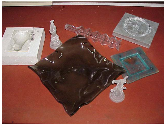
Figura 5 Peças em vidro obtidas com tecnologias de conversão, a partir de modelos de PR..
