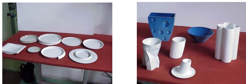
Figura 2 Protótipos em LOM (desenvolvidos no INEGI por alunos da Universidade Lusíada) pintados para apreciação de produtos e correcção de erros de projecto.
