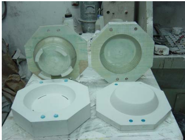
Figure 4 Moldes em gesso vazado directamente sobre contramoldes em LOM.
