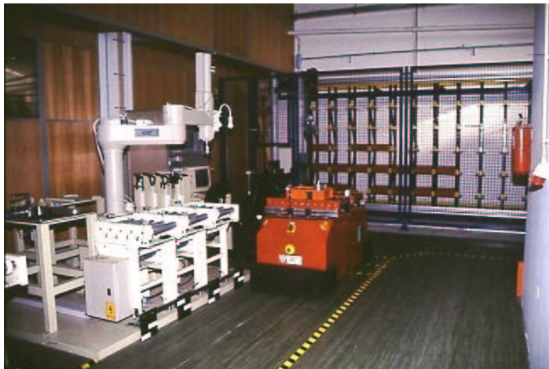
Fig. 4 - Vista parcial da área de fabrico mostrando o AGV e o armazém automático (ao fundo)
