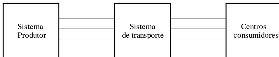
Fig. 13.2 - Representação esquemática de um sistema eléctrico, para estudos de fiabilidade, considerando o sistema de transporte.
