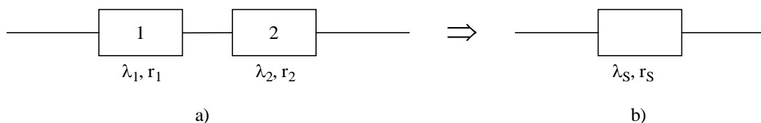
Fig. 8.7 – a) Sistema constituído por dois componentes ligados em série. b) Modelo equivalente do sistema.
