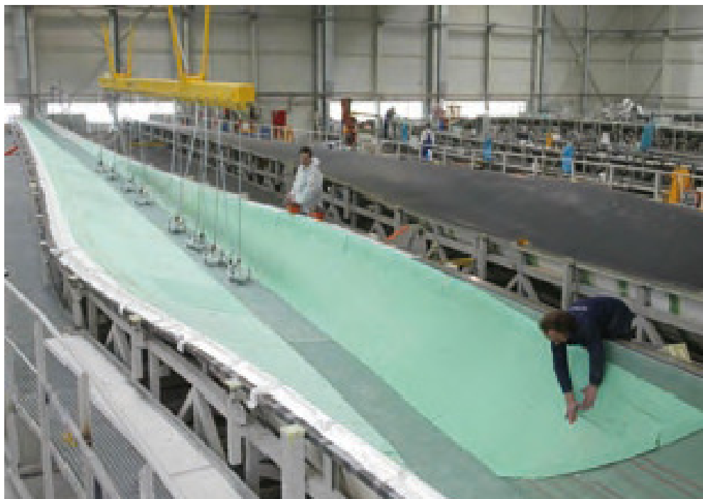
Figura 28 – Fabrico de um painel de uma pá
