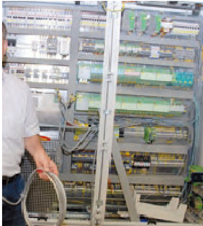
Figura 27 – Fabrico de um painel de controlo
