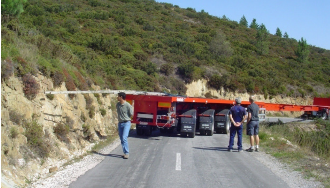
Figura 45 – Comprovação da passagem das pás
