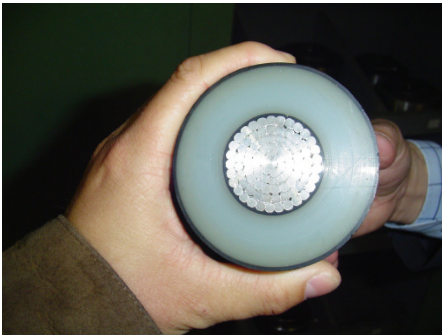
Figura 35- Cabo de média tensão de 240mm
