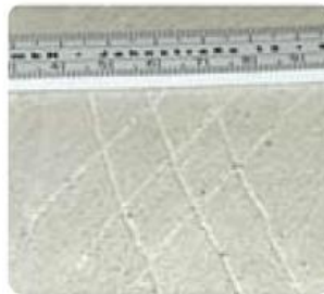
Fig. 5.1 – Ensaio de avaliação da dureza e coesão do suporte por risco de prego. [31]
