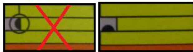
Fig. 5.6 – Aplicação correcta da cola. [3]
