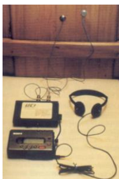
Fig. 3.7 – Aparelhos para detecção acústica de insectos xilófagos.
