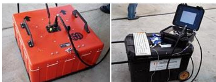
Fig. 3.6 – Unidade central e antena de um georradar.
