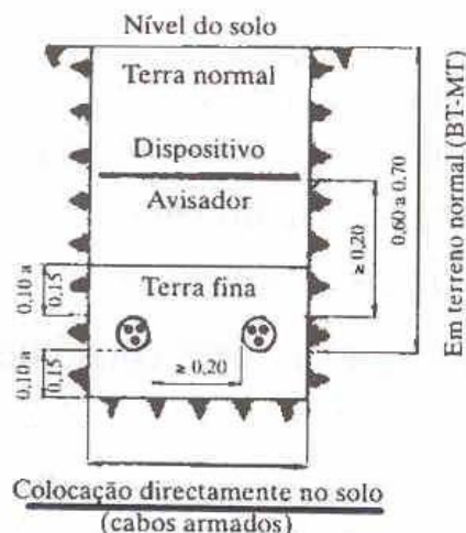
Fig. 13a: Canalização Colocada Directamente no Solo.
