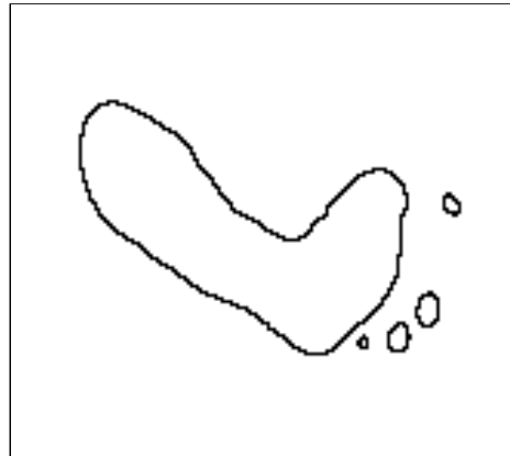
resultado de operação local lógica para detecção dos bordos dos objectos
