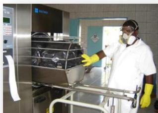
**Figura 11:** Unidade de autoclavagem
