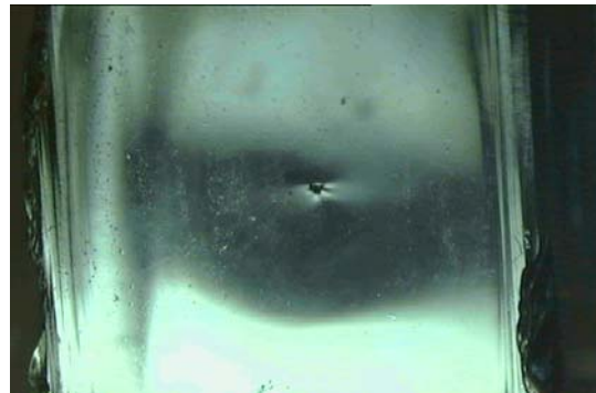
Fig.2.-Observación MOR de la partícula de NiS en el vidrio.
