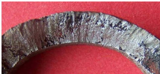
Figura 6. Macro de la Zona B, mostrando las playas de fatiga asociadas a un proceso de propagación de fisuras.
