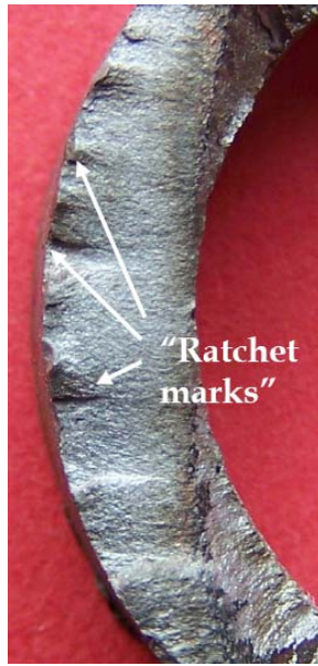
Figura 5. Macro de la Zona A, mostrando las marcas de trinquete asociadas a múltiples puntos de iniciación de la fatiga.
