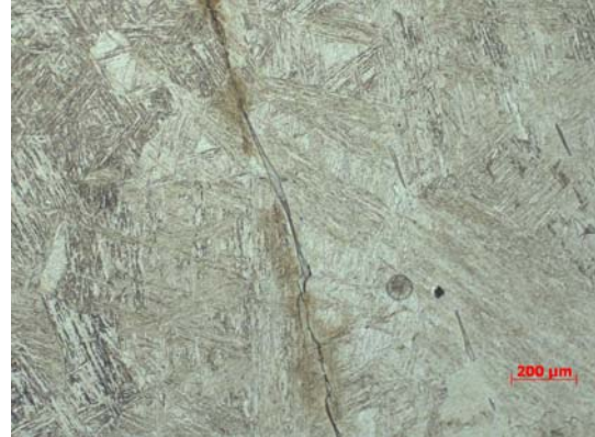
Figura 12. Fisura localizada en el interior de la muestra 9
