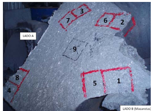
Figura 2. Fotografía mostrando la rotura de la turbina Pelton
