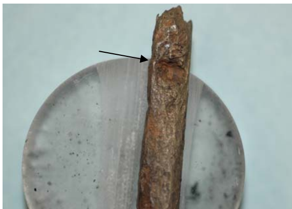
Figura 2. Superfície de fractura de um varão fracturado segundo fácies de tipo frágil, em “ponta de
