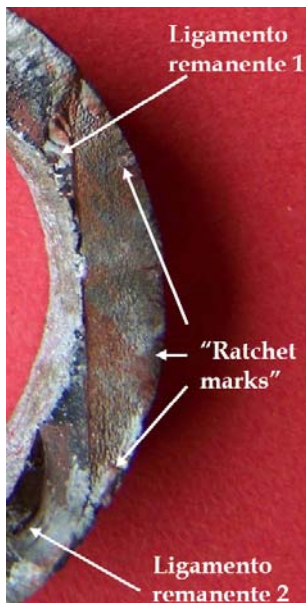
Figura 7. Macro de la Zona C, mostrando las marcas de trinquete y los dos ligamentos remanentes.
