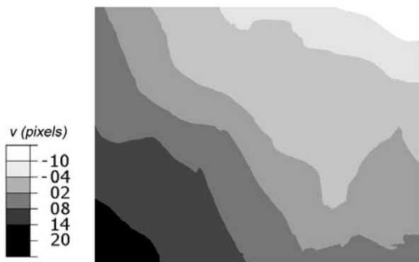
Figura 3. Contornos de desplazamientos en la dirección de aplicación de la carga, obtenidos experimentalmente mediante la técnica de correlación digital de imágenes.
