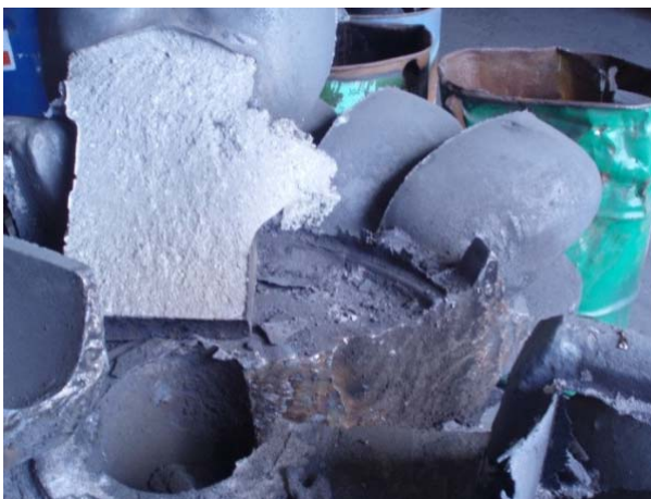
Figura 2. Fotografía mostrando la rotura de la turbina Pelton
