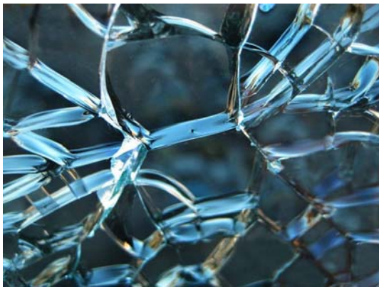
Fig.1.-Observación visual de la partícula de NiS en el vidrio fracturado
