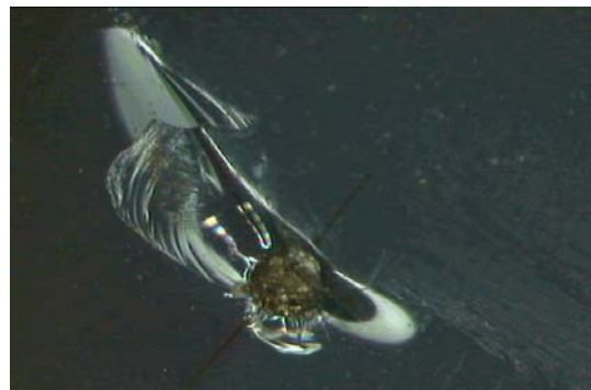
Fig.3.-Observación MOR de la partícula de NiS en el vidrio
