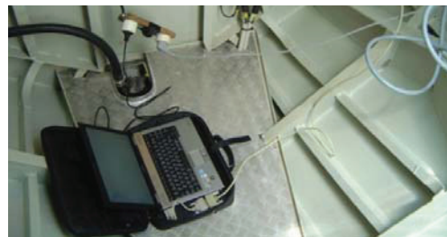
Figura 8. Extensómetro colado na Antepara e equipamento instalado a bordo
