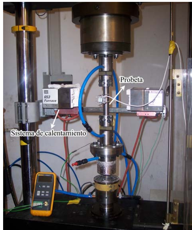
Figura 1. Ensayo de fatiga uniaxial de bajo número de ciclos realizado sobre un tubo de Inconel® 625 a 650 °C.
