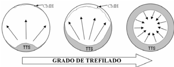
Figura 8. Esquema seguido por las superficies de fractura según el grado de trefilado, para velocidades de sollicitación rápidas.
