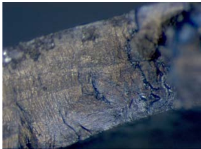
Figura 10. Superficie de propagación de la grieta de fatiga en la probeta 3. Se observa una propagación muy plana siguiendo la zona afectada por el calor adyacente a la soldadura.
