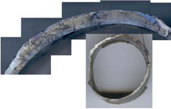
Figura 9. Superficie de propagación de la grieta de fatiga en la probeta 2. Se observa una rugosidad asociada a los sucesivos cordones de soldadura.
