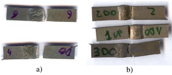
Figura 7. Probetas de tracción ensayadas a a) 570 °C y b) 650 °C. El origen del fallo se localiza en las cercanías de la soldadura.
