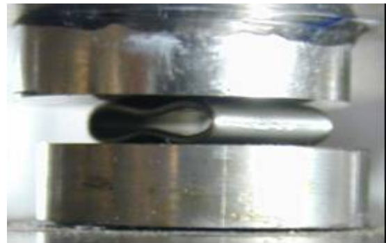
Figura 2. Probeta de compresión diametral al final del ensayo.
