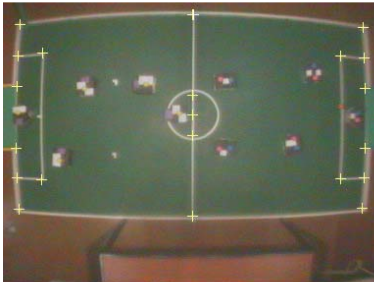
Figura 5.7: Os pontos de calibração do mapeamento de coordenadas
