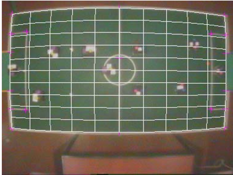
Figura 5.8: A compensação da distorsão em barril
