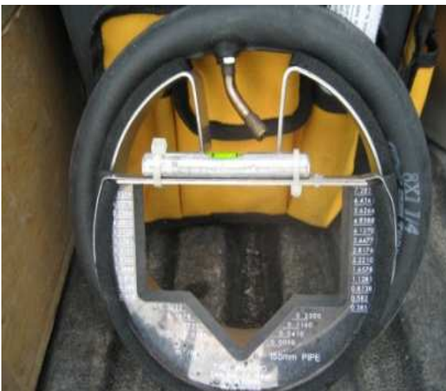
Figura 5. Descarregador calibrado Weir.
