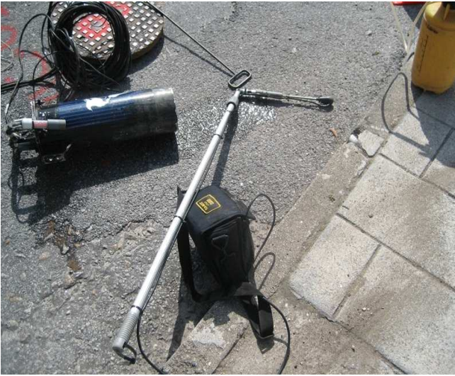
Figura 4. Medidor de velocidade portátil utilizado para calibrar os medidores ultrasónicos.
