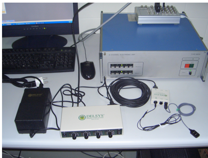
Figura 3.7. Sistema Bagnoli da Delsys para recolha do sinal electromiográfico de superfície com transmissão por cabo.
