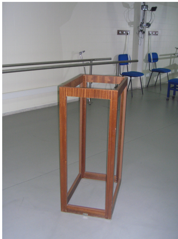
Figura 3.11. Objecto usado no laboratório de movimento do CRPG para calibrar o espaço 3D sobre a plataforma de forças.
