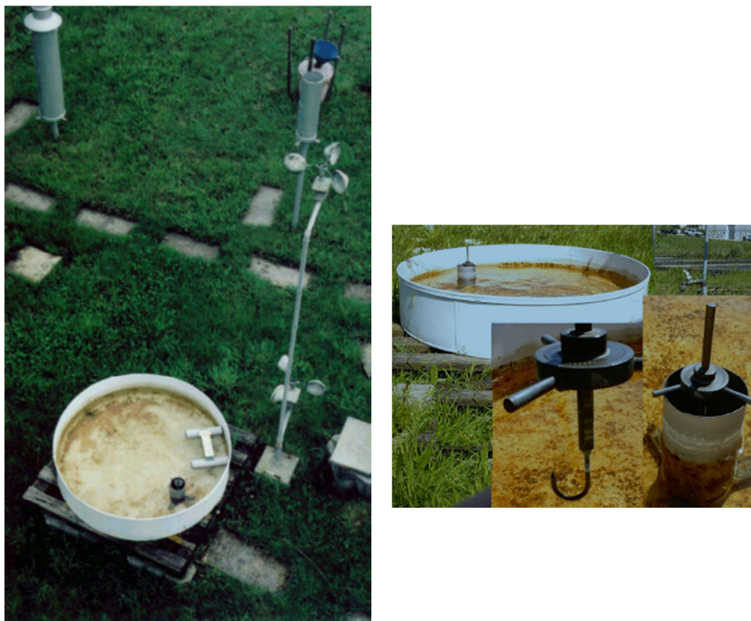
Fig. 1 - Tina de evaporação Classe A com anemómetros e pormenor do instrumento de medida.
