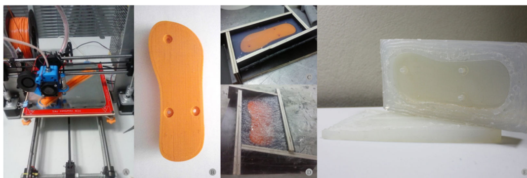
Fig. 3 - A) Processo de fabrico aditivo em impressora de baixo custo; B) Modelo em PLA; C) Vazamento do Silicone; D) Câmara de vácuo com molde inclinado; E) Molde de Silicone.
