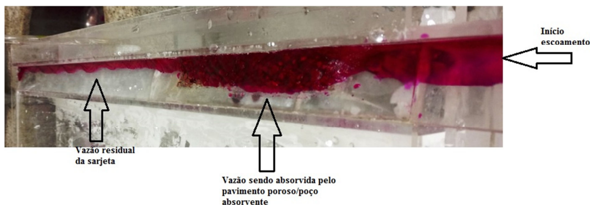
Fig. 6 - Visualização superficial do início, absorção e escoamento residual a jusante do poço absorvente.
