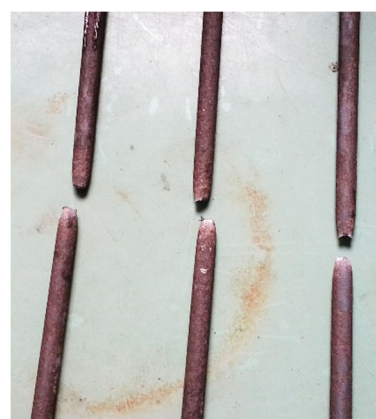
(c) Amostras do tirante após o ensaio de tracção
