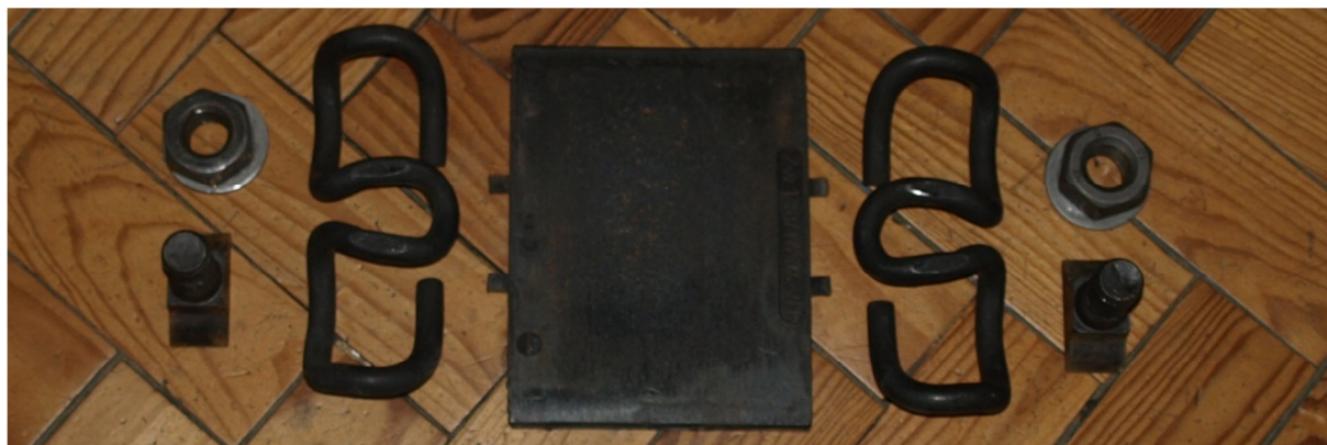
Fig. 21 -. Componentes da fixação do tipo SKL12
