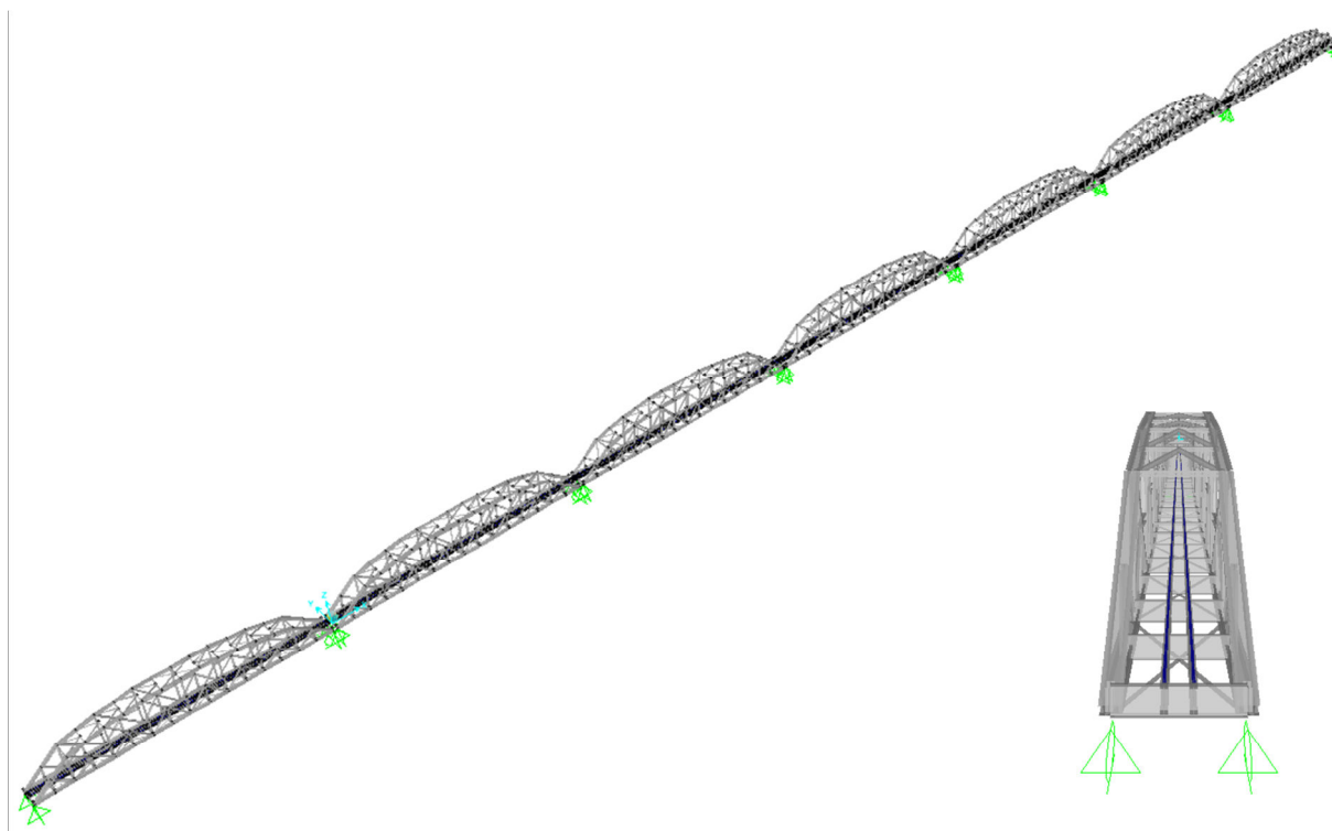
Fig. 27 - Modelo dos tramos intermédios da viga treliçada de 80 m (Oliveira e Silveira, 2014)
