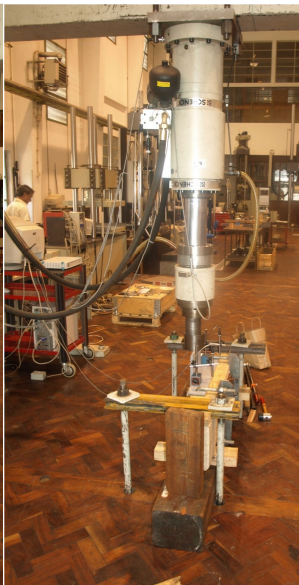
Fig. 13. Sistema de ensaio da ligação travessa-ponte
