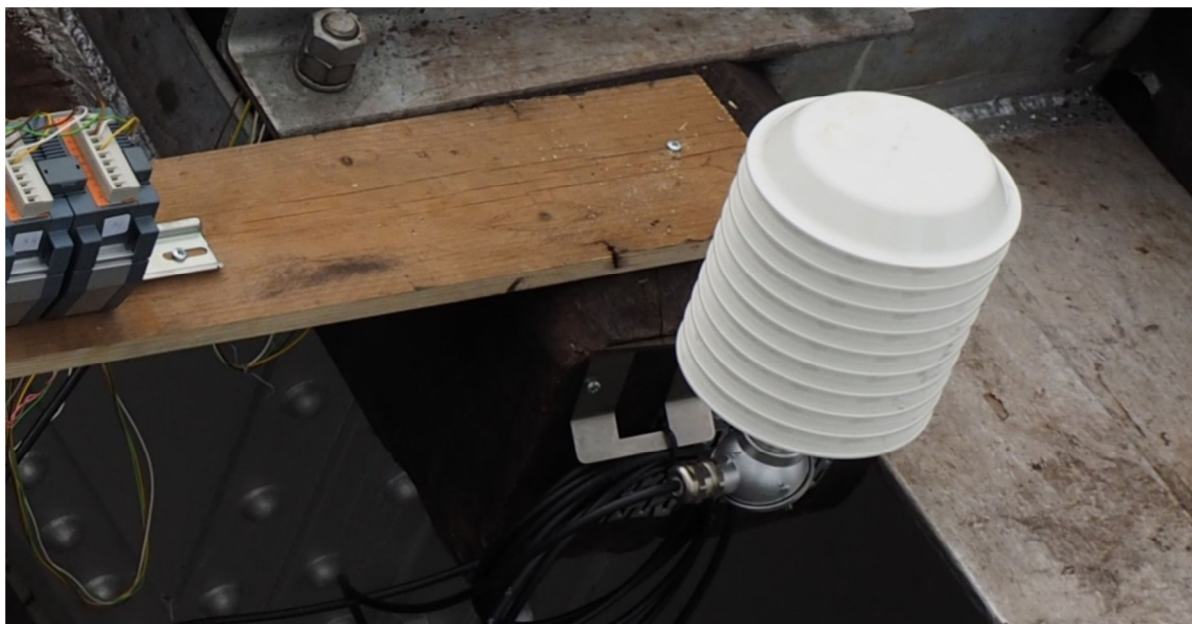
Fig. 39 - Sensor para medição da temperatura e humidade relativa do ar
