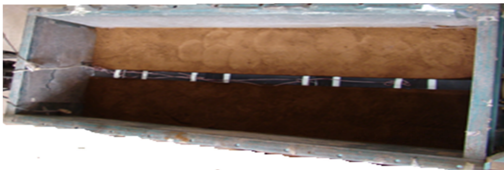
Fig. 11 - Inserção da fita polimérica no maciço (Maparagem, 2011)
