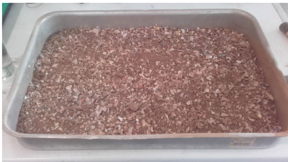
Fig. 4 - Mistura do solo com o resíduo plástico.
