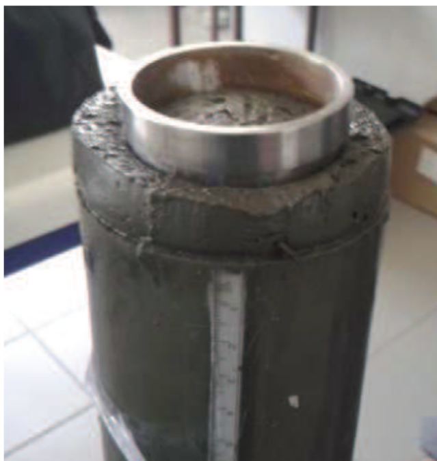
Fig. 5 - Cravação do anel do edómetro.
