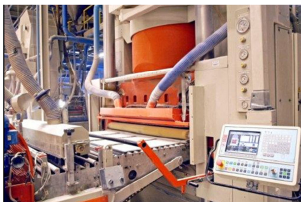
Fig. 9 - Prensagem e secagem (Franco, 2009)
