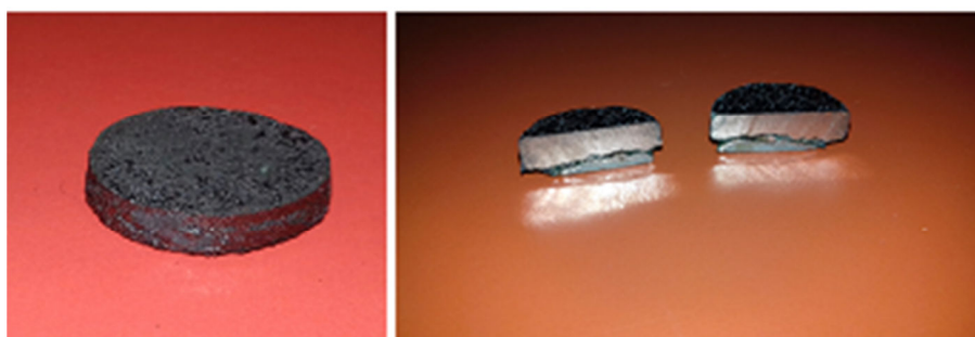
Fig. 1 - Amostra o corpo de prova da liga formada antes e depois do corte ao meio.
