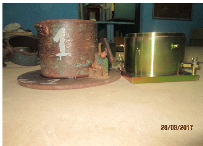
Fig. 7 - Ilustra moldes de compactação para diferentes normas.
