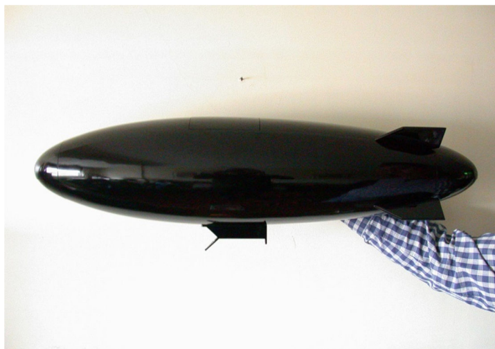
Fig. 5 - Forma final do modelo AS800, sendo visíveis a gôndola, as derivas e a caixa de fixação à balança da AFA.
