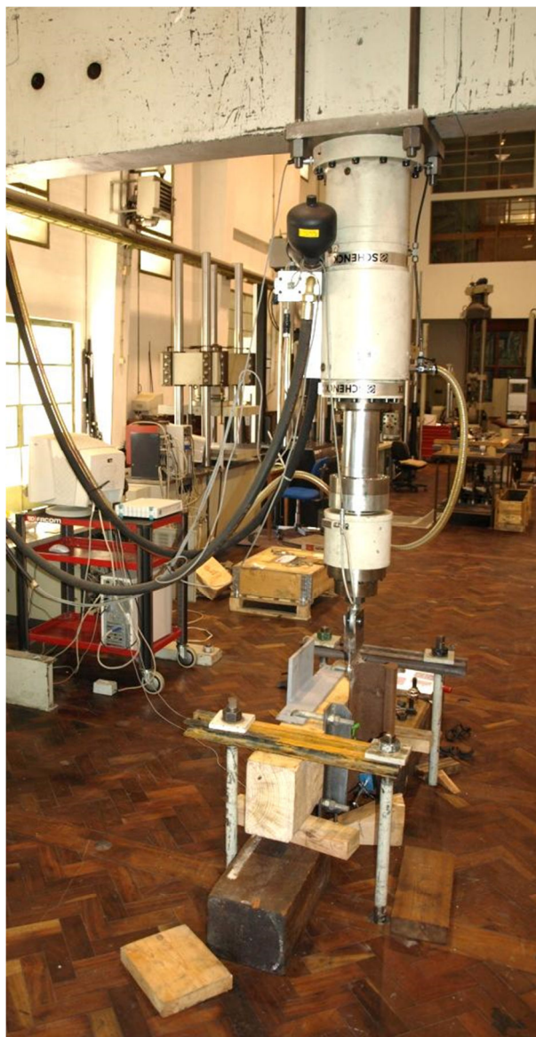
Fig. 12 - Sistema de ensaio para as fixações
