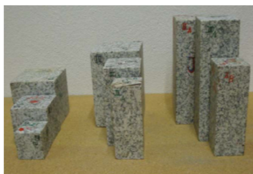
Fig. 1 - Geometria dos Provetes
