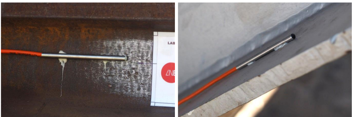
Fig. 38 - Termómetros para medição da temperatura do carril e da estrutura
