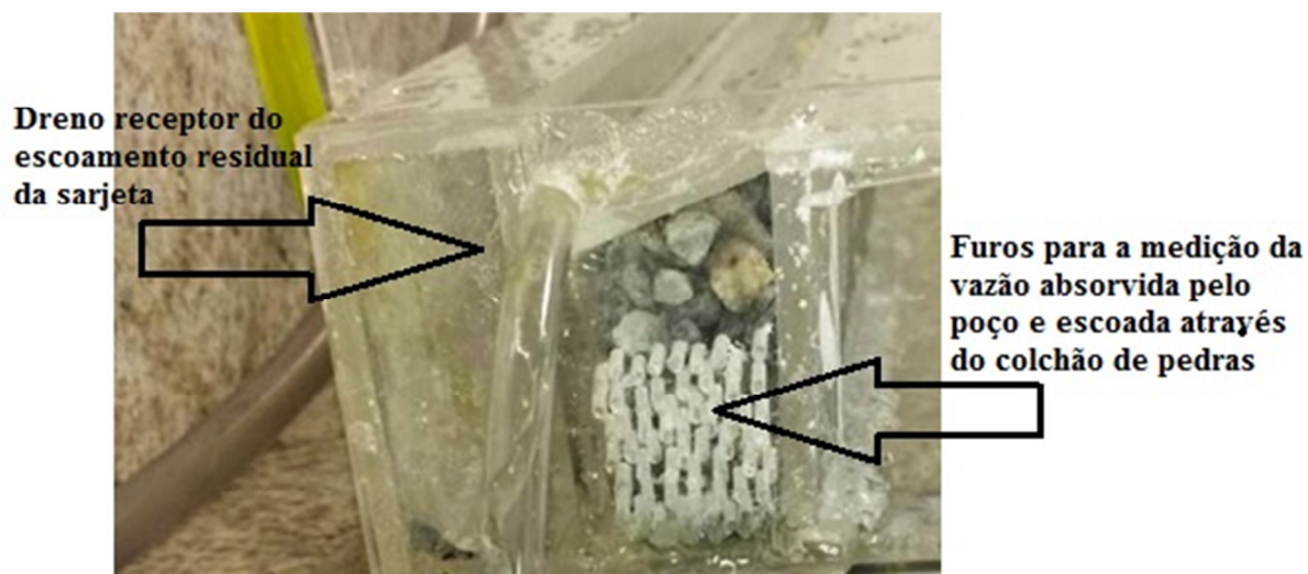
Fig. 5 - Detalhe do dreno receptor do escoamento da sarjeta e da tomada para medição da vazão infiltrada/retida
