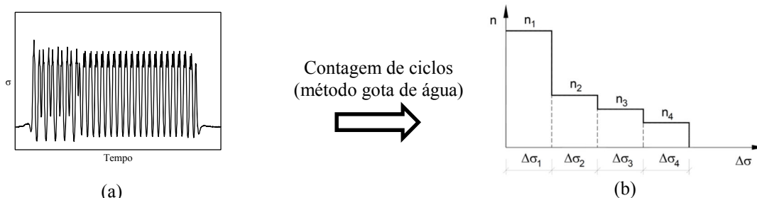
Fig. 29 - (a) Historial de tensões; (b) Espectro de tensões
