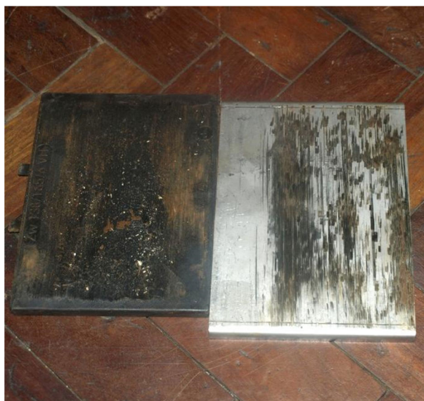
Fig. 18 - Ensaio cíclico das fixações SKLU12: desgaste - chapa de inox e palmilha de borracha
