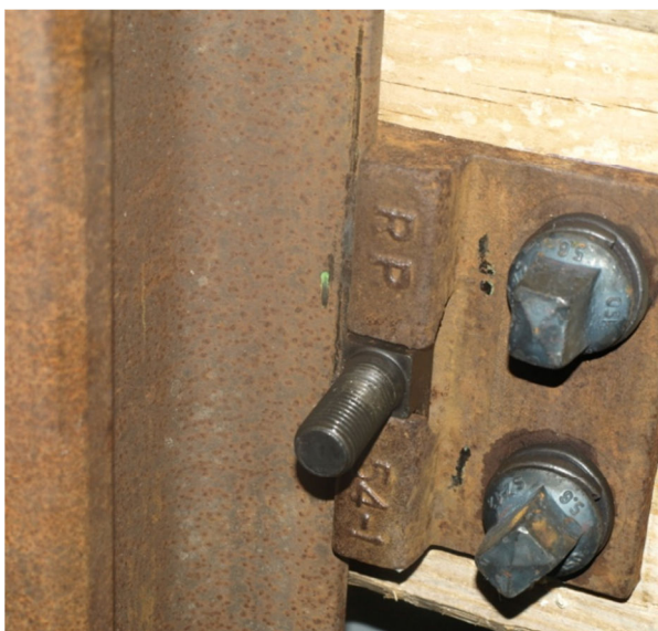
Fig. 19 - Ensaio cíclico das fixações SKLU12: desgaste - carril
