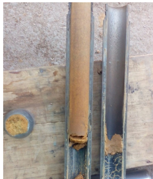
b) Amostrador SPT, com amostra de solo
