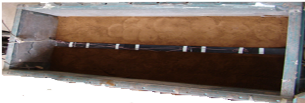
Fig. 11 - Inserção da fita polimérica no maciço (Maparagem, 2011)
