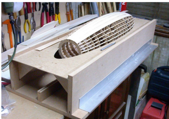
Fig. 2 - Mesa de montagem do modelo. Com as longarinas, gomas, aros e sendo bem visível o perfil em L para fecho da mesa.
