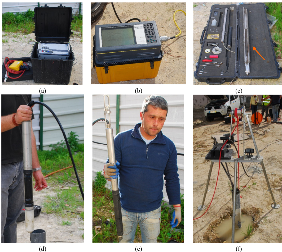
Fig. 6 - Alguns aspetos da execução dos ensaios CH, com sparker , no campo experimental: (a) gerador de impulsos e unidade de controlo; (b) sismógrafo; (c) calha com bússola para sparker nas ondas S; (d) sistema de aquisição tri-axial; (e) sonda sparker ; (f) aspeto geral da sonda sparker instalado no furo.
