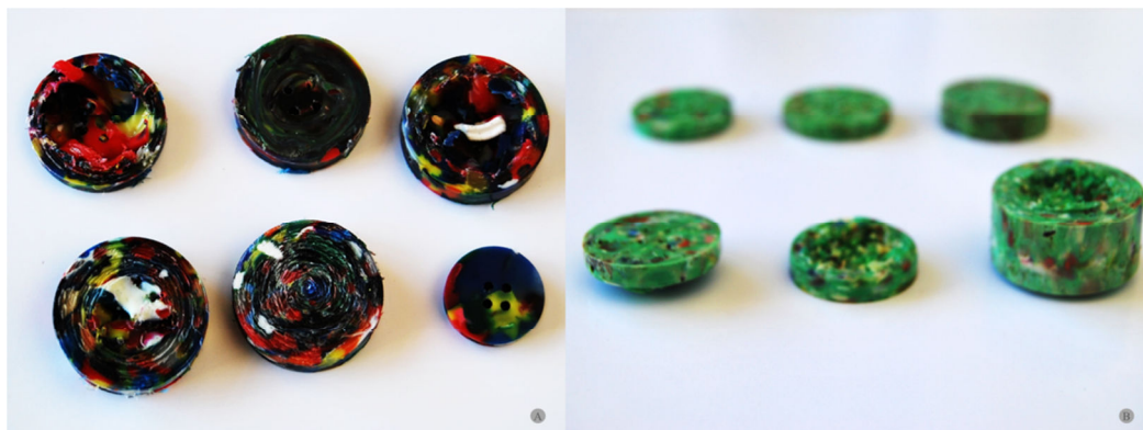
Fig. 6 - A) Resultados de experiências com PE/PP após o corte; B) Resultados de experiências com PET verde após o corte.
