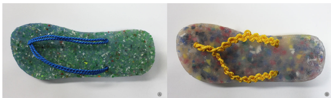
Fig. 9 - A) Protótipo de havaiana em PET; B) Protótipo de havaiana em PE/PP.
