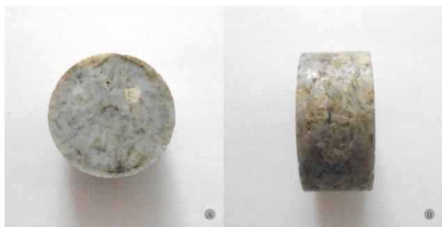
Fig. 5 Resultados de duas experiências após o arrefecimento com PET Azul: A) Vista de topo; B) Vista frontal.
