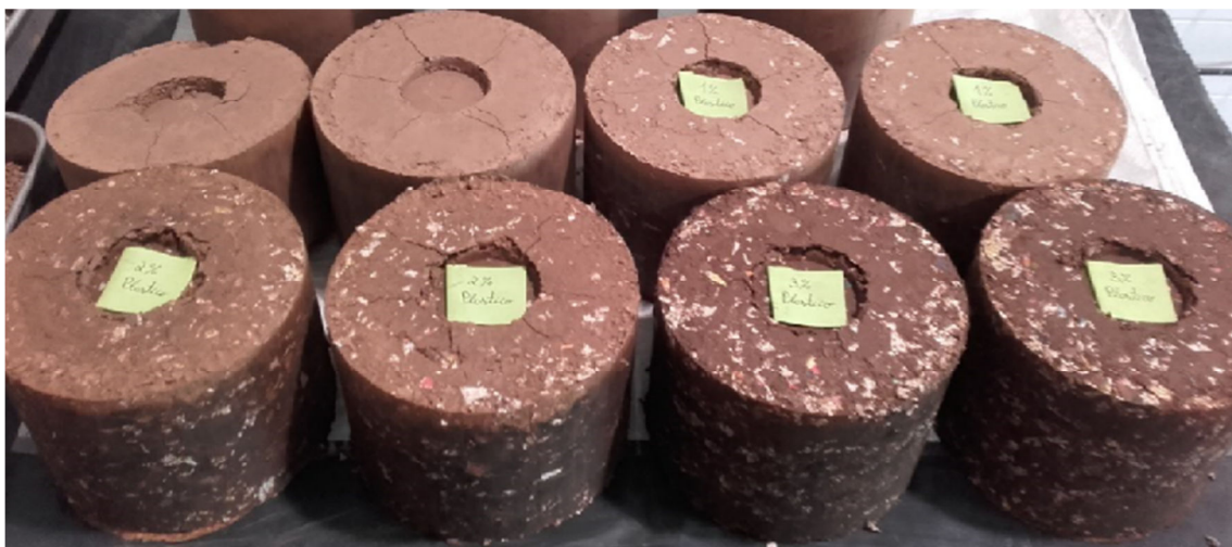
Fig. 5 - Aspecto dos provetes CBR com 0%(em cima à esquerda), 1% (em cima à direita), 2% (em baixo à esquerda) e 3% (em baixo à direita).
