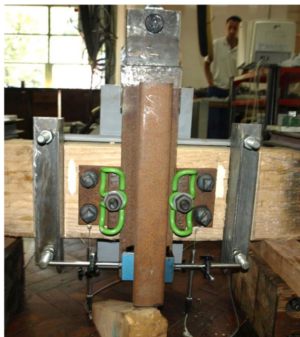
Fig. 11 - Protótipo do ensaio das fixações
