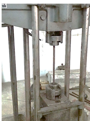
(b) Ensaio de tracção em amostra dos tirantes de aço
