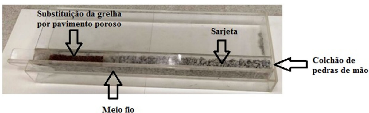
Fig. 4 - Vista do modelo reduzido em acrílico com as referidas substituições para o estudo
