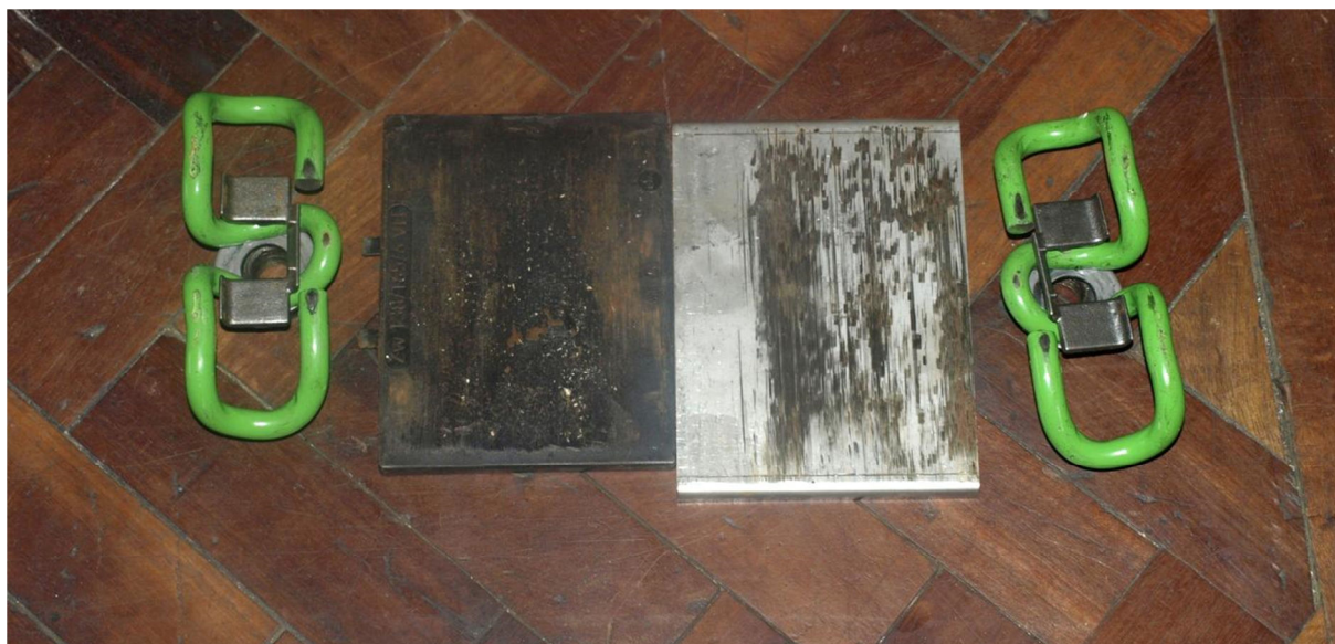
Fig. 17 - Ensaio cíclico das fixações SKLU12: desgaste - vista geral
