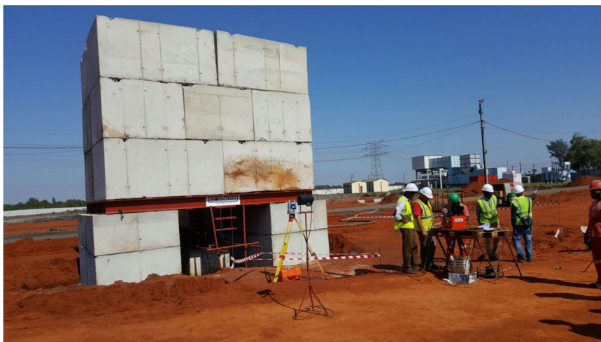
Fig. 1 - Ensaio de carga vertical estático à escala real.
