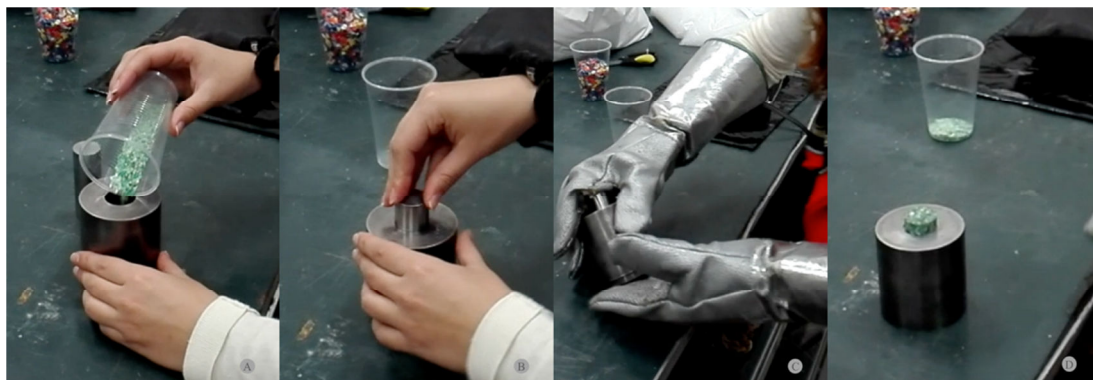
Fig. 4 - A) Introdução de partículas no molde metálico; B) Prensagem manual; C) Remoção da peça do seu interior; D) Ejeção da peça.
