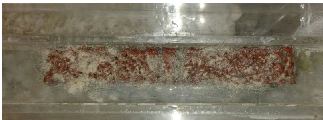
Fig. 3 - Detalhe do preenchimento do pavimento poroso com areia
