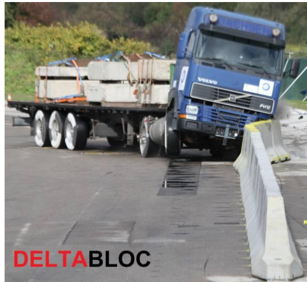
Figura 4 – Sistema DB100 H4b W5. Ensaio TB 81- Energia Cinética do veículo no Embate – 724,6 kJoule
