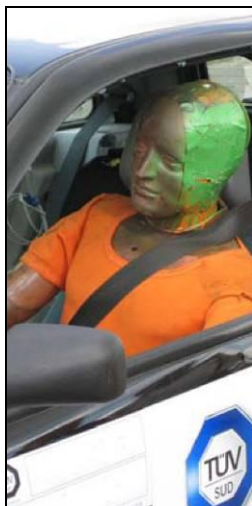
Figura 5 – Crash Test Dummie utilizado em Ensaio TB11 para simulação de passageiro no veículo. Classificação do Índice ASI da barreira de contenção.
