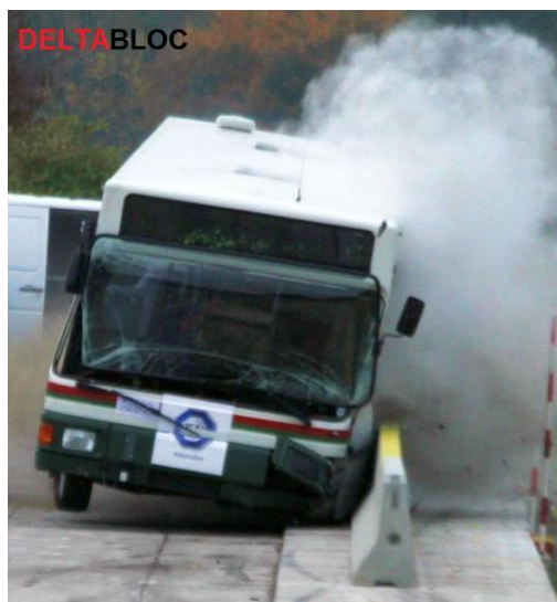
Figura 7 – Sistema DB80 AS-A H2 W1 ASI-B. Ensaio de Contenção TB51 - E.C. 287,5 kJoule
