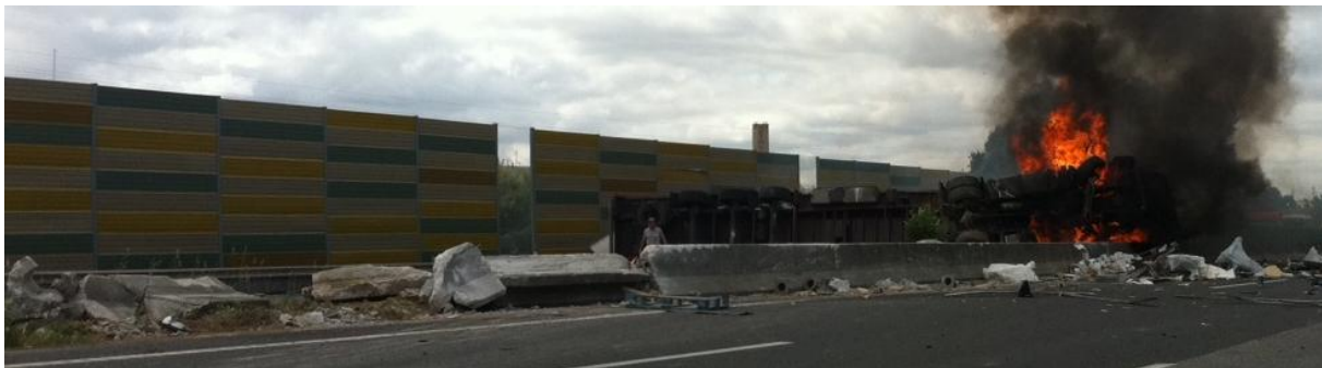
Figura 3 – Acidente na A1 (Vila Franca de Xira) 2 de Junho/2011. O despiste deste veículo pesado destruiu a barreira destinada a protecção e entrou na faixa contrária de rodagem. Um sistema de retenção adequado evitaria os graves danos humanos e materiais verificados. (foto cedida por GAIA FM)
