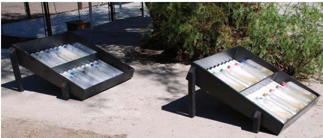
Figura 15.7. Unidades de remoción THC durante su operación en el poblado de Camarones, Arica, Chile.
