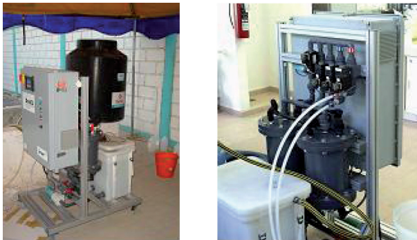
Figura 17.4. Izquierda: equipo de desionización capacitiva con reservorios de agua cruda y tratada. Derecha: Celdas capacitivas y válvulas solenoides para agua cruda y tratada.
