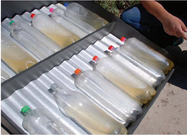
Figura 15.6. Proceso de tratamiento de aguas mediante la tecnología THC.
