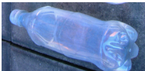
Figura 12.2. Botella de plástico PET impregnada con \text{TiO}_2 según procedimiento desarrollado en el laboratorio [14].
