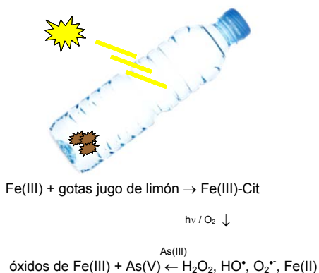
Figura 5.1. Esquema del método SORAS. Oxidación del As(III) a As(V) a través de los oxidantes formados fotoquímicamente y posterior coprecipitación de los oxihidróxidos de hierro y el As(V).
