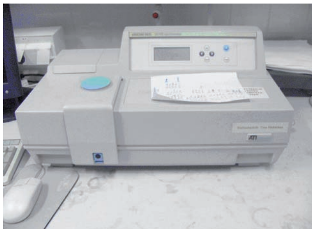
Figura 3.10. Fotografía de un equipo de espectrofotometría UV-Vis con arreglo de diodos.
