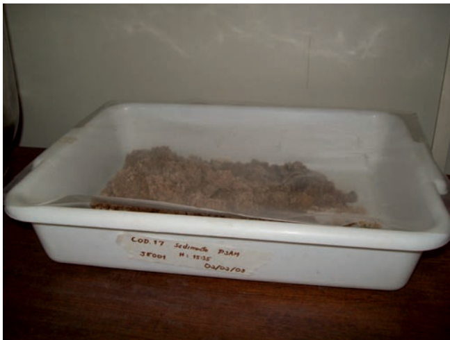
Figura 2.2. Ejemplo de secado de una muestra de sedimento en una bandeja de polietileno protegida de la contaminación externa (secado a temperatura ambiente).
