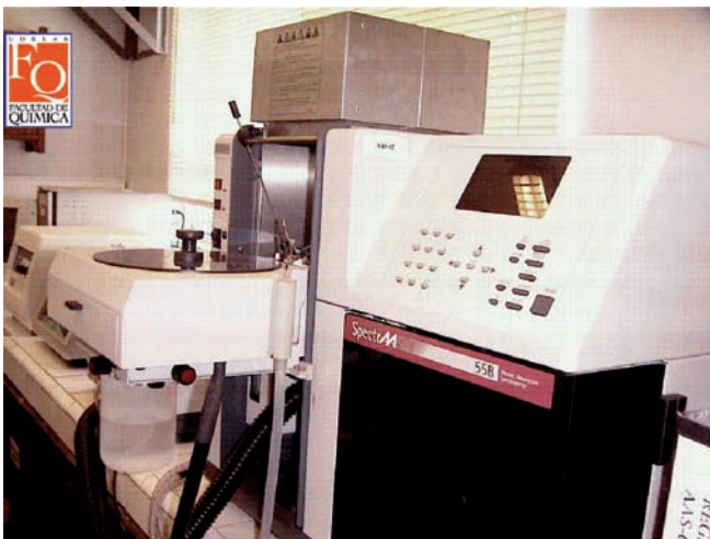
Figura 5.1. Fotografía de un equipo de espectrofotometría de absorción atómica
