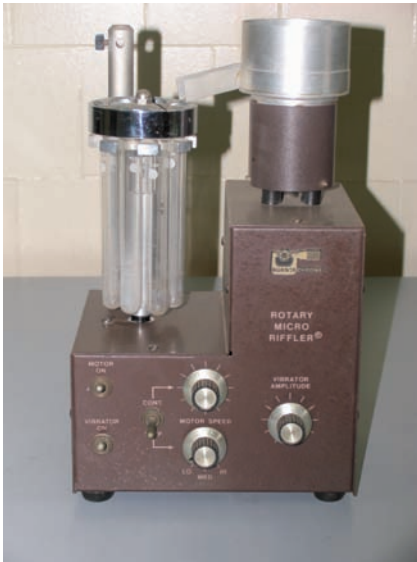
Figura 2.4. Ejemplo de muestreador rotativo de Rifles.
