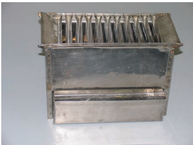
Figura 2.3. Ejemplo de cuarteador del tipo “Jones” utilizado para muestreo.
