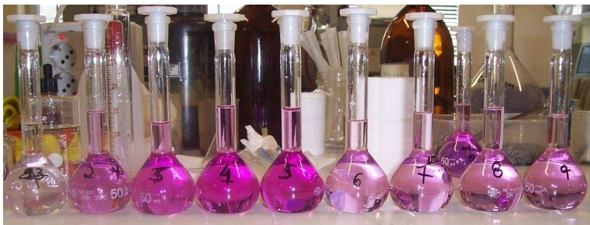
Solução de crómio (VI) após complexação pela difenilcarbazida.
