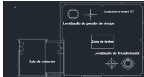
Figura 4.1: Áreas do LAT e respetiva localização dos equipamentos. O sistema de gerador de choque e de frequência industrial possuem mobilidade de forma a manter as distâncias de segurança; [11]
