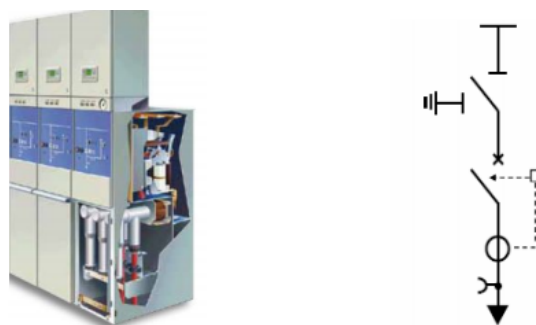
Figura 3.6: AIS Típico com tecnologia com disjuntor extraível e o seu diagrama unifilar; [9]
