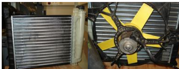
Figura 7.7 - Radiador/Permutador de calor, e respectivo ventilador
