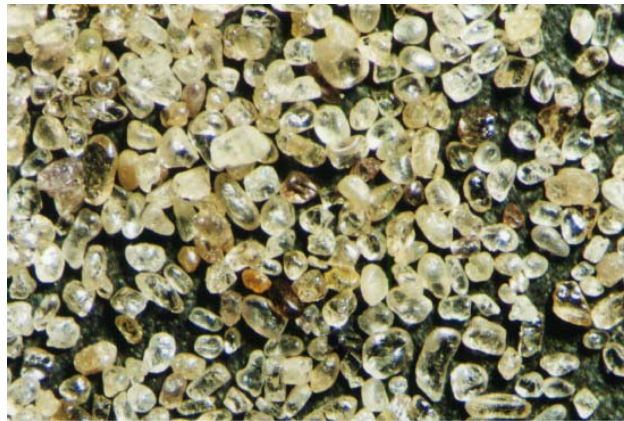
Figura 5 Silicato de zircónio comercial. Partículas redondas com uma distribuição de tamanhos de 100 a 180 \mu\text{m} . Fotografia estereográfica (microscópio estereográfico Olympus SZH).
