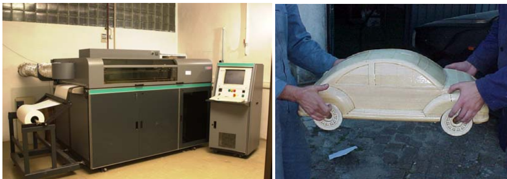
Figura 8 a) Equipamento de prototipagem rápida LOM do INEGI, e b) modelo do novo “Beetle” (em papel) da Volkswagen feito por prototipagem rápida (processo LOM).
