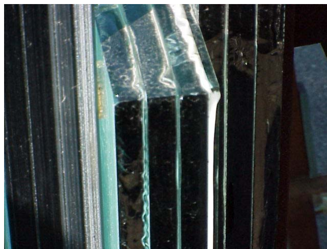
Figura 13 Vidro à prova de choque. Entre as 4 placas de vidro temperado foram colocadas várias camadas de película de PVB (poli vinil butiral), as quais são responsáveis por absorção de uma grande quantidade de energia (cortesia da Vitropor).
