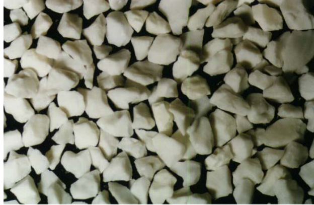
Figura 4 Molochite comercial. Partículas facetadas com uma distribuição de tamanhos de 180 a 300 \mu\text{m} . Fotografia estereográfica (microscópio estereográfico Olympus SZH).
