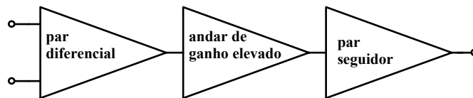
fig. 54 – Diagrama de blocos dum amplificador do tipo dum AmpOp
