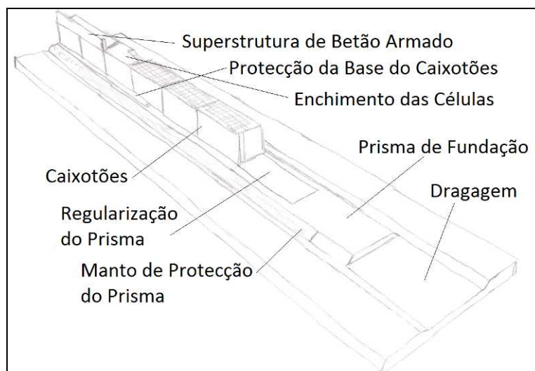
Fig. 2.57 – Esquema construtivo de um quebramar de parede vertical.
