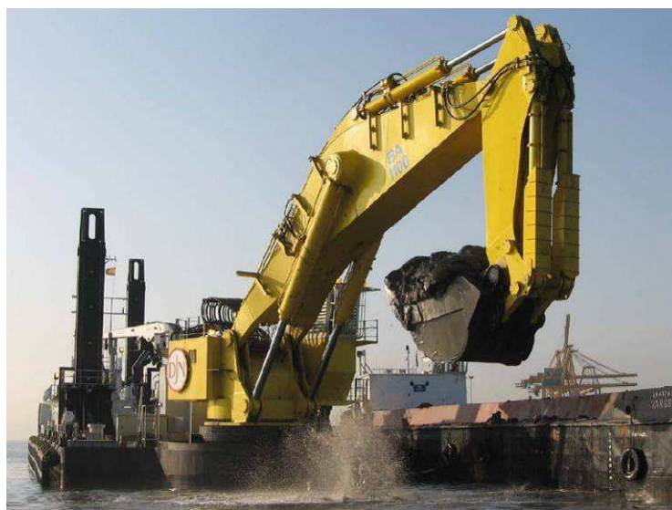
Fig. 2.40 – Dragagem retroescavadora (Backacter BA1100) [54].
