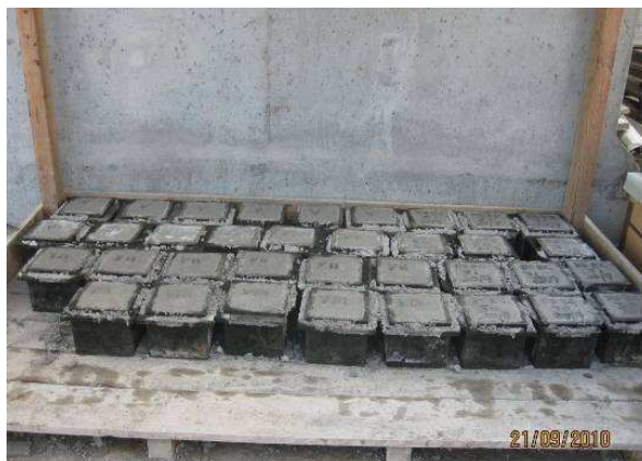
Fig. 4.7 – Provetes (cubos) de betão para ensaio.
