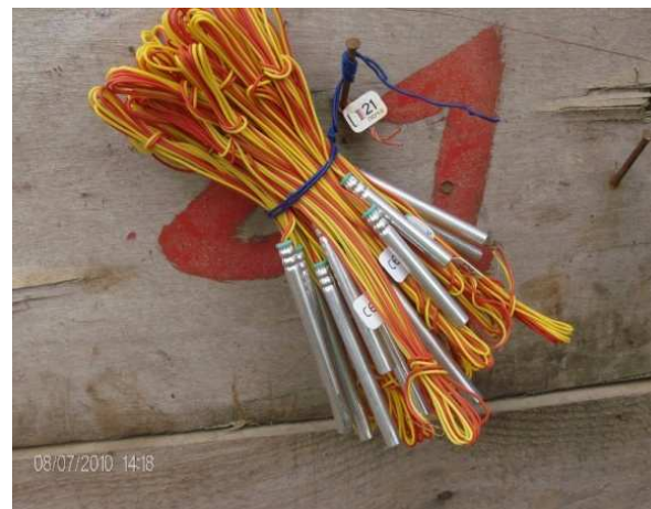
Fig. 3.37 – Explosivos Emulex 731 e detonadores de micro-retardo.
